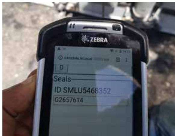
Figura 40 – Lector para el escaneo de los códigos de barras de los sellos o precintos de seguridad de los contenedores utilizado actualmente en puerto Río Haina – Fuente: Edwin Vargas
